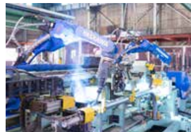
溶接ロボット
